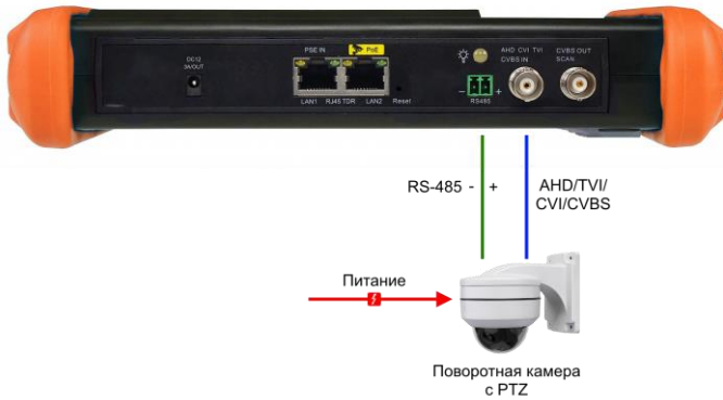
Рис. 8 Подключение управляемой по RS-485 поворотной PTZ видеокамеры к тестеру (на примере тестера TIP-H-7)
